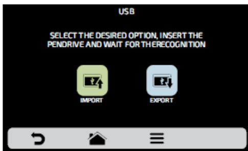
**c)** При выборе одной из функций появится сообщение: «Вставьте USB-диск и дождитесь распознавания» (*Insert USB disk and wait for recognition*).
